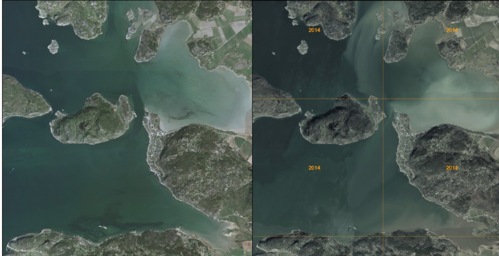
Figur 2.1. Vinddriven resuspension av sediment. Bilden till vänster visar Ålgöfjorden i Kungälv kommun under lugna väderförhållanden där de två vikarna Lökebergskile och Ödsmålkile ses till höger i bild. Dessa vikar täcktes till stora delar av ålgräsängar under 1980-talet, vilka sedan dess har försvunnit. Bilden till höger visar samma område efter västliga vindar då vågor grumlat upp sedimentet på grunt vatten vilket orsakar "moln" som täcker stora delar av området. Studier visar att efter en period med vind kan fina lerpartiklarna i vattnet försämma siktdjupet dramatiskt under flera dagar. Idag är ljusstillgången i dessa vikar för dålig för att ålgräs skall kunna växa på de djup där ängarna hittades på 1980-talet. Bilderna är geometriskt korrigerade flygfoton (s.k. ortofoto) från Svenska Lantmäteriet.
