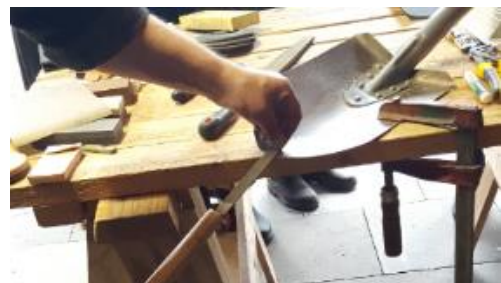
Patrik vässar en spade som fästs vid arbetsbänken med hjälp av en skruvtving. Lägga märke till hur långt ner han håller sin fil med extra långt skaft.
