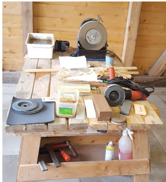
På Patrik Jarefjälls arbetsbänk kan man se våtslipmaskinen, vinkelslipen, slippapper och olika typer av brynen och filar.
