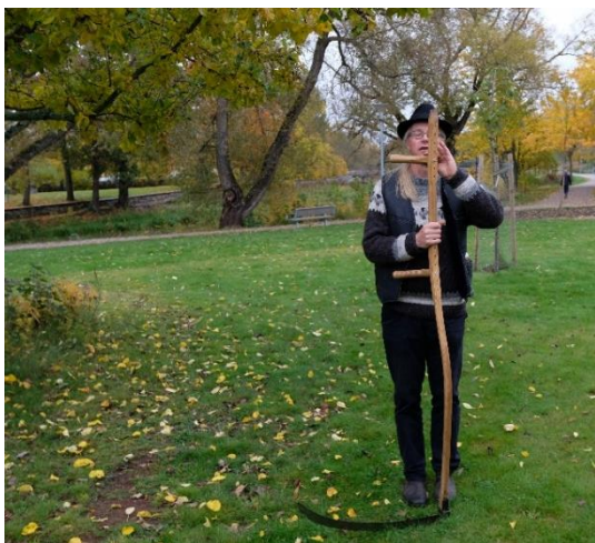
Bild 3 Mats visar hur långt orvet skall vara och vart handtagen skall ligga (Myr, R. 2019)
