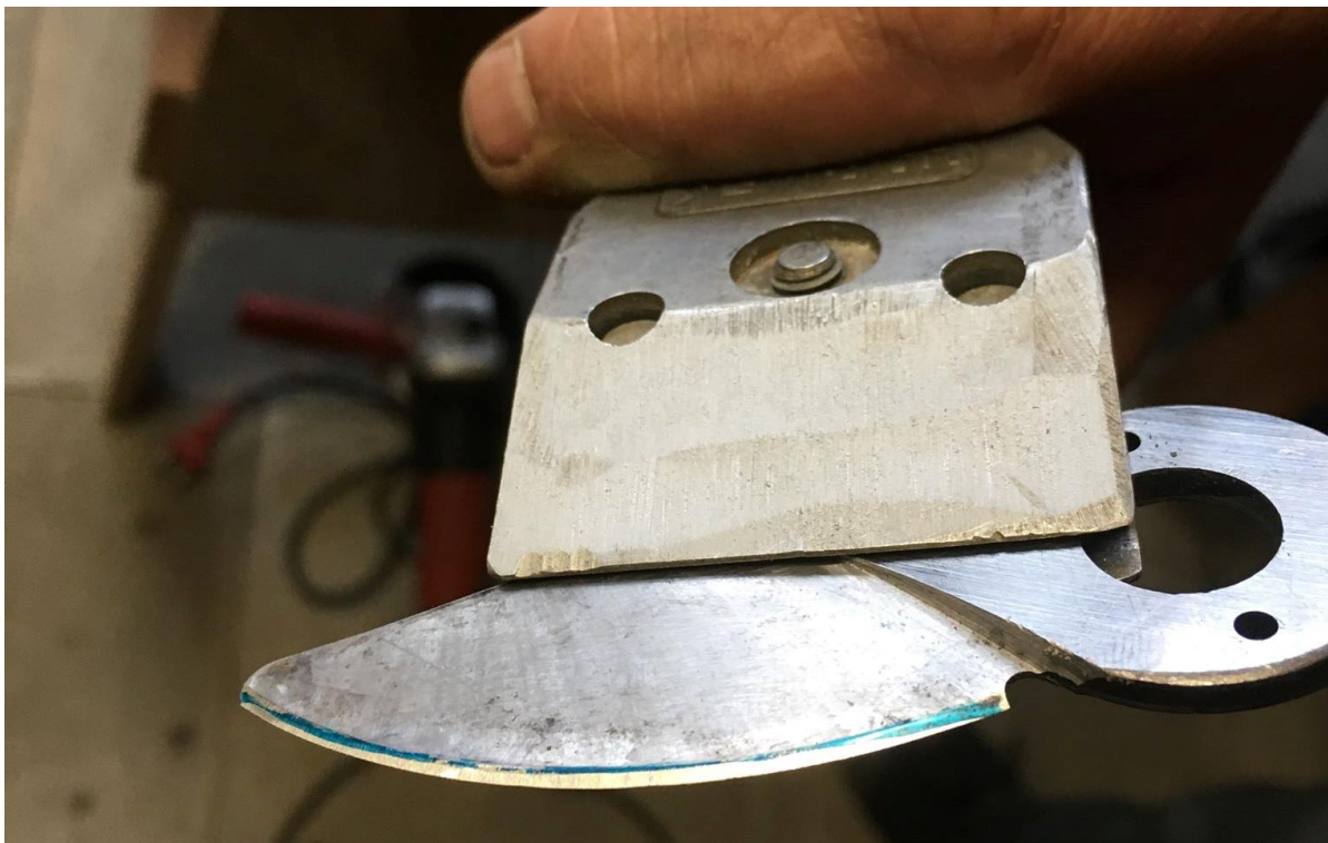
På bilden sitter sekatorbladet stadigt förankrat i en tving. Längs med bladet ser man även en tuschlinje som Patrik ritat för att kontrollera att han slipat hela eggen.
